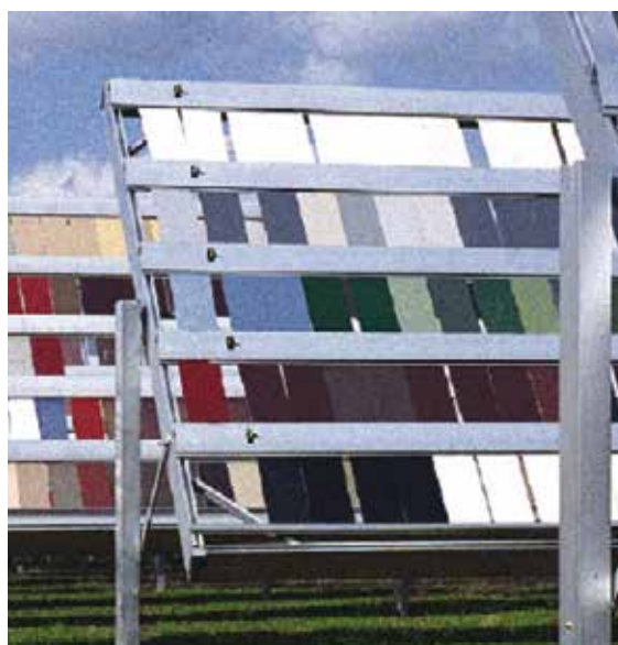
Rastrelliere per l'invecchiamento accelerato dei materiali
